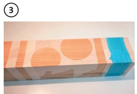
3 Das Klebeband der eingeschnittenen Kreisfläche abziehen.
