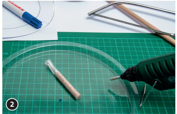
Mit der Handsäge einen ca.  $\varnothing$  8 mm Buchenrundstab in drei ca. 5 cm lange Teile sägen. Einen weiteren Rundstab auf eine Länge von ca. 35 cm kürzen (wird später benötigt). Die kleinen Stab-Teile mit Frischhaltefolie umwickeln.
