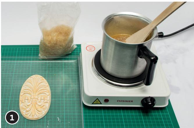
Eine Formbaumasse mit großartigen Anwendungsmöglichkeiten. Formaform besteht aus kleinen, gummiartigen Granulatkörnern, die in einem Topf im Wasserbad, wie Wachs erwärmt und geschmolzen werden. Dabei entsteht eine dickflüssige Formbaumasse, die mit dem der Packung beigelegten Verflüssiger: Formaform-Liquid im Verhältnis 100 : 40 vermischt wird.
