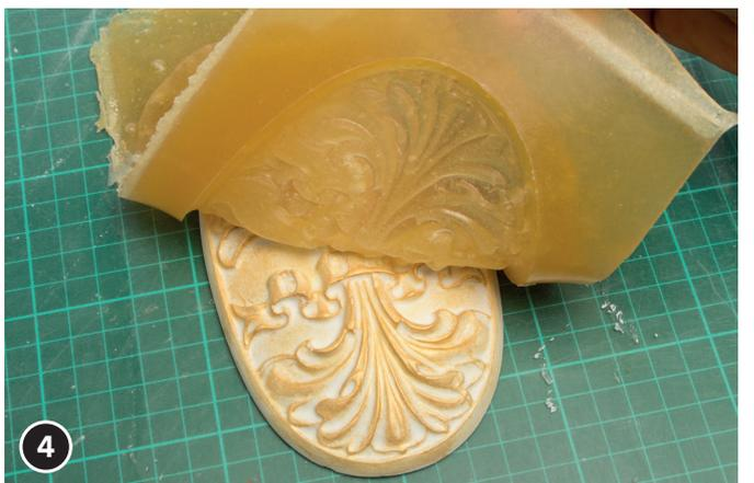
Leider ist sie aber nicht beständig gegen Hitze und wasserhaltige Gießmaterialien. Deshalb kann die Gießform jederzeit wieder eingeschmolzen werden, was einzigartige Vorteile gegenüber anderen Formbaumassen bietet. Deshalb wird eine nicht gelungene, nicht einwandfreie Form wieder eingeschmolzen.
