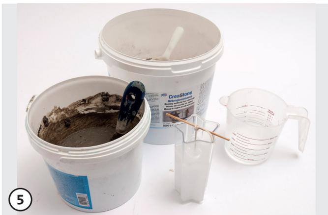
5 Kreativ-Beton nach Produktbeschreibung anrühren. Die restliche Stern-Gießform mit Beton auffüllen (Docht verbleibt in der Gießform). Beton ca. 1 – 2 Tage aushärten lassen.
