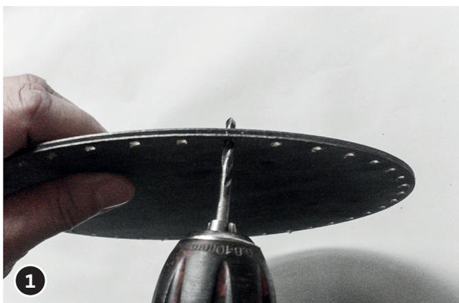
Die Löcher in der Bodenplatte mit dem Akkuschauber um 4 mm vergrößern.
